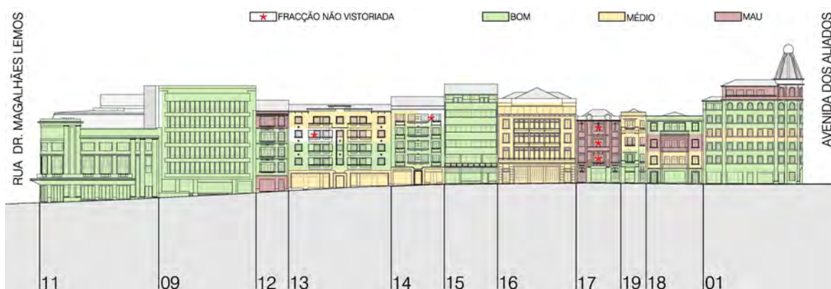
Alçados da Rua do Bonjardim e da Rua de Rodrigues Sampaio – Estado de Salubridade (Piso a Piso)
