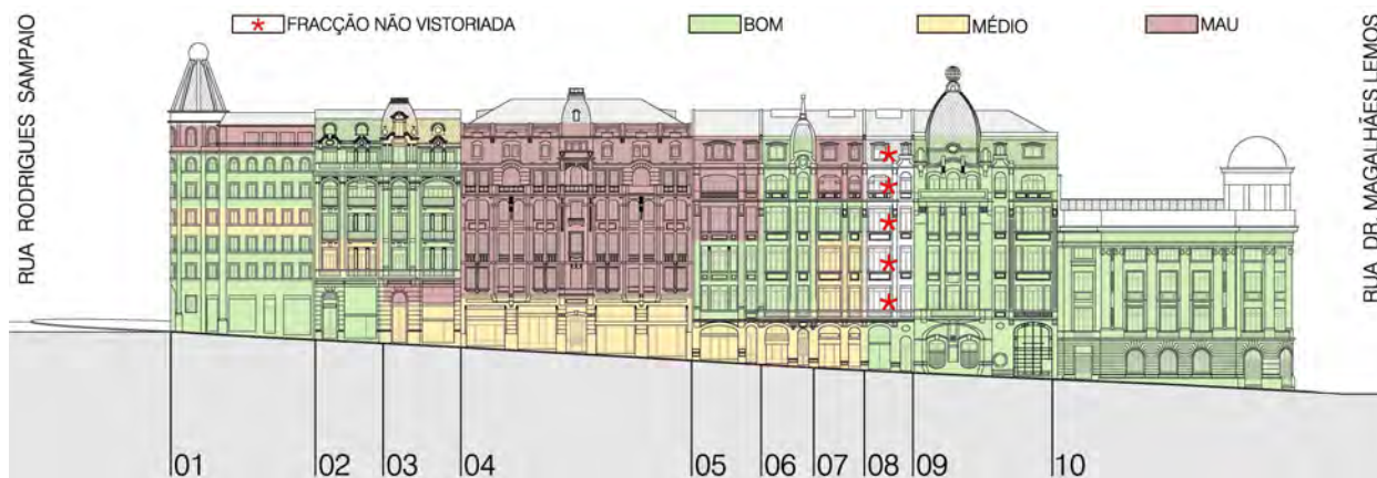
Alçado da Avenida dos Aliados – Estado de Salubridade (Piso a Piso)
