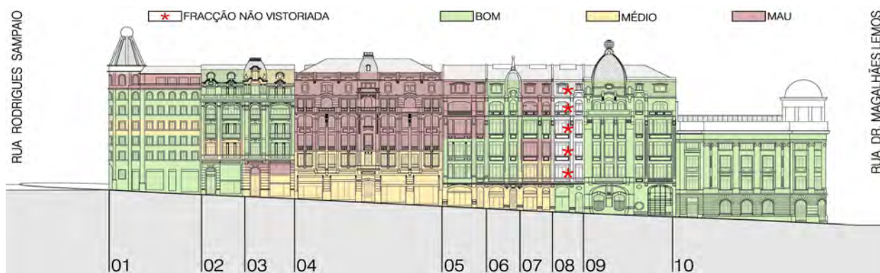
Alçado da Avenida dos Aliados – Estado de Conservação (Piso a Piso)
