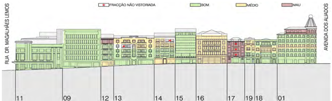
Alçados da Rua do Bonjardim e da Rua de Rodrigues Sampaio – Estado de Conservação (Piso a Piso)
