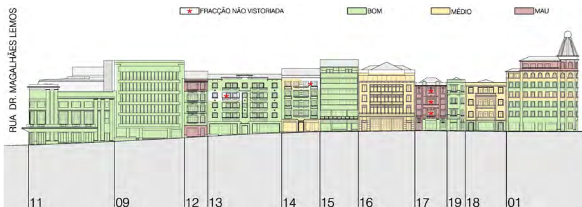
Alçados da Rua do Bonjardim e da Rua de Rodrigues Sampaio – Estado de Estética (Piso a Piso)
